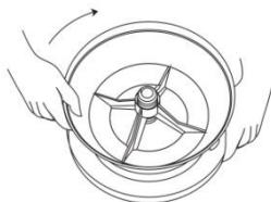
Puis vissez le réglage sur la vis jusqu'en butée (le bord épais du réglage d'aliment vers le bas)
