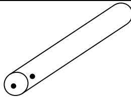
Percer 2 trous à l'extrémité du tube télescopique
