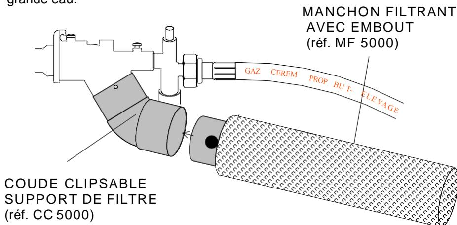
Ne pas démonter le coude, seul le manchon filtrant avec embout se retire.
