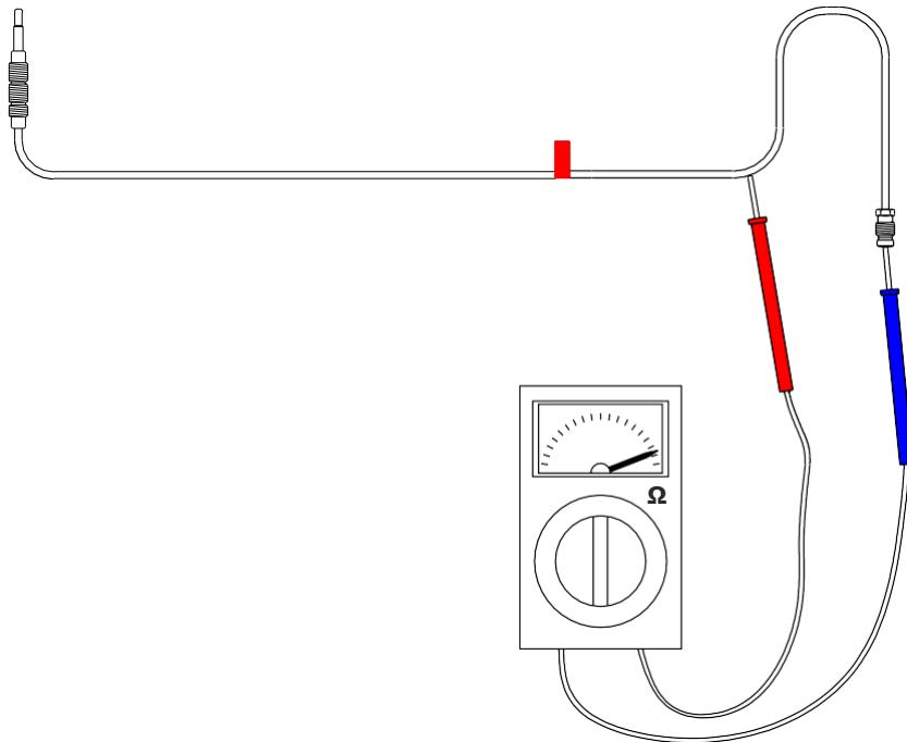
Si le fusible thermique est grillé, l'appareil a subi une combustion interne et le thermocouple est définitivement hors d'usage.
