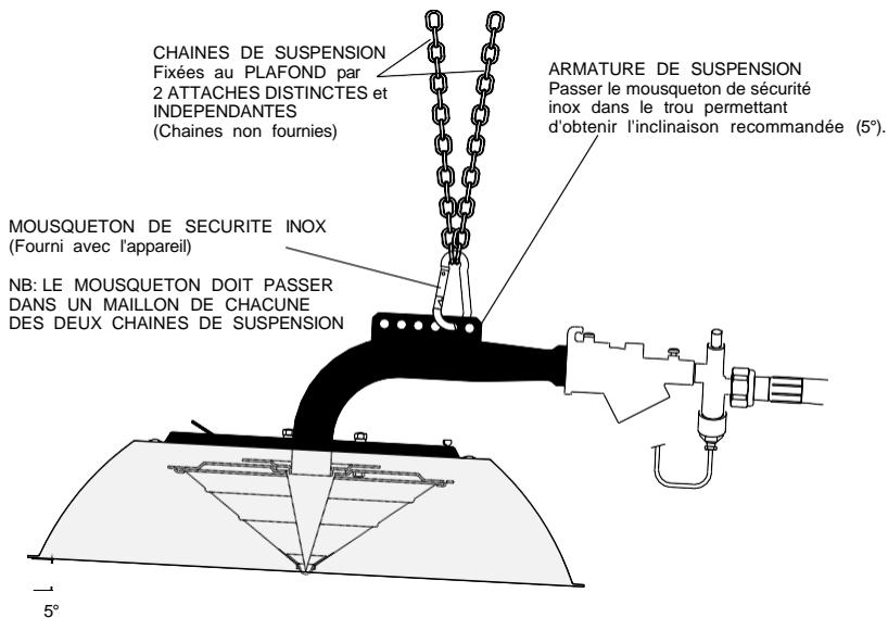
La BASE DE LA COPOLE doit être légèrement RELEVEE vers l'avant (5° D'ANGLE avec L'HORIZONTALE)
