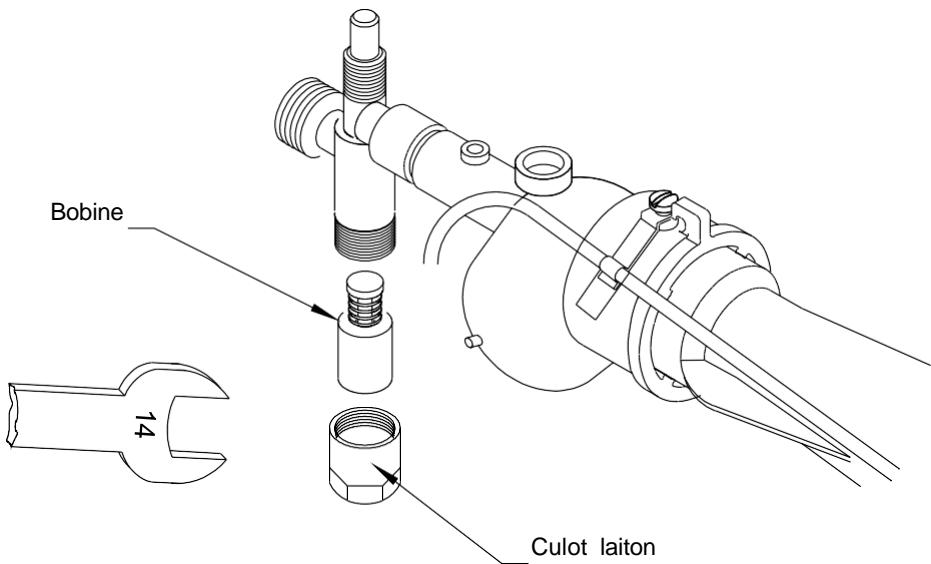
Si le radiant ne fonctionne toujours pas, il s'agit sûrement de l'usure du thermocouple.
